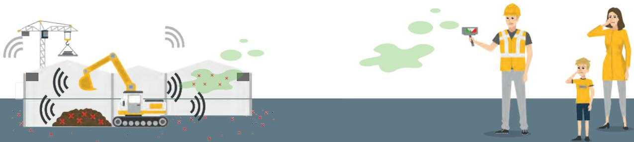
Neben der Reduzierung von Staub und Lärm bieten die Hallen insbesondere Schutz vor schädlichen Gasen. Im Inneren wird die Abluft abgesaugt und in großen Aktivkohlefiltern von Schadstoffen befreit.
